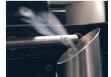
Les systèmes d'extraction de fumées DPX de Domino filtrent efficacement les fumées et les particules générées par le processus de codage.
